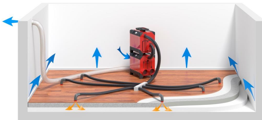
Osuszanie w trybie tłoczącym. Do pompy doprowadzane jest suche powietrze z osuszacza i wtłaczane w konstrukcję warstwową.
