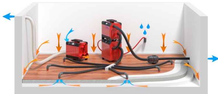
Osuszanie w trybie ssącym. Osuszacz osusza powietrze w pomieszczeniu a pompy zasysają powietrze z konstrukcji. Powstałe podciśnienie zasysa powietrze do konstrukcji.
